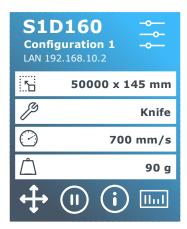
FIG 1-4 MEDIA IS LOADED AND THE CUTTER IS READY
