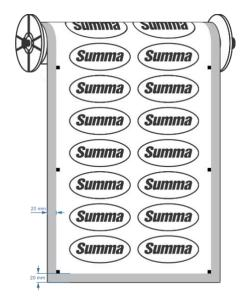
FIG 3-1 MARGINS PRINTING ON A ROLL
