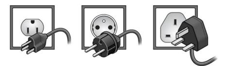
FIG 1-1 EXAMPLE OF PROPERLY GROUNDED PLUG-SOCKET COMBINATION
