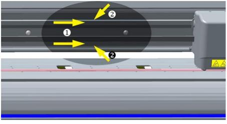
FIG 5-3 SLIDING SURFACES ON Y-GUIDE RAIL
